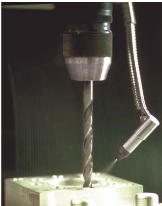
Szerszámhűtés és -kenés környezetkímélő levegő-köpenyben
